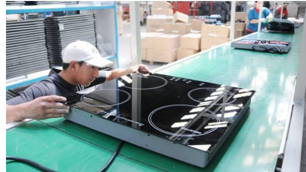
Armado de una cocina de inducción
