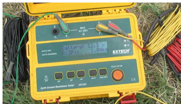
Fotografía 3: Medición de resistividad en SE Catamayo
