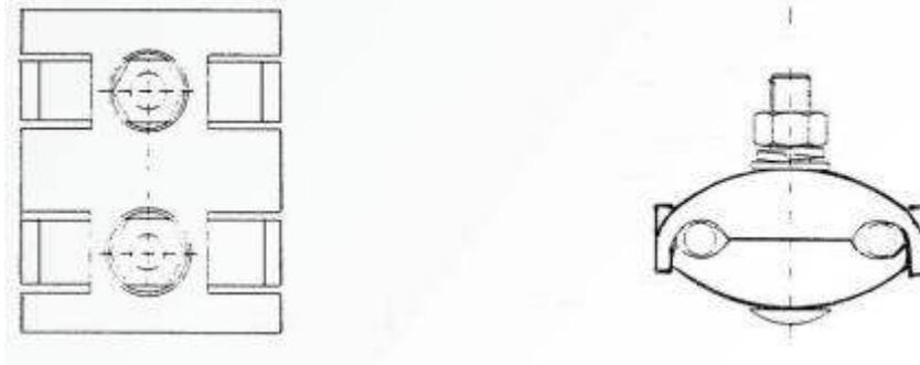
Para la selección del rango del conector, se deberá considerar que el mismo será instalado sobre las varillas de armar del cable OPGW de un lado y del otro lado, al conductor de puesta a tierra bajante.
